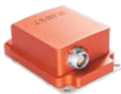
MTi 包括: 57x42x23.5 mm, 52g, 9 引脚推拉式连接器
